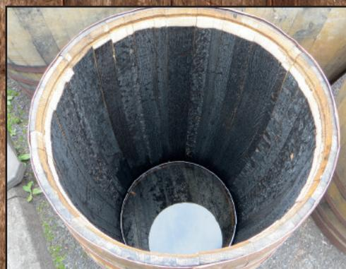
**Abb. 4-7** Durch das Auskohlen der Fässer wird das Holz aktiviert, Lignin wird chemisch abgebaut und die feine Holzkohleschicht wirkt als Aktivfilter für unerwünschte Geruchs- und Geschmacksbestandteile des Destillats.
